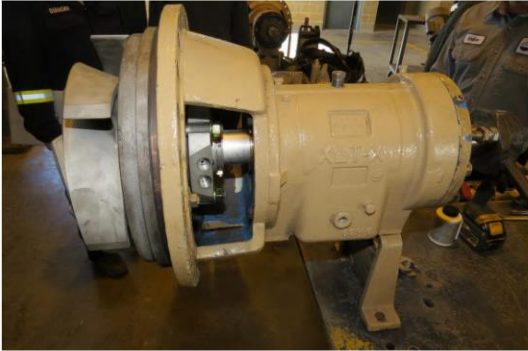
Fig. 4 – Exemplar Seal Chamber
